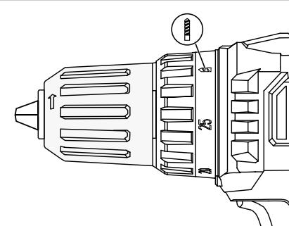
Во избежание травм, не заворачивайте шурупы в положении (для сверления) муфты крепящего момента – при блокировании крепежа изделие передаст на Вас высокий крывающий момент.
