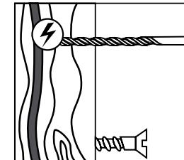
При сверлении стен / заворачивании крепежа в стены предварительно убедитесь в отсутствии в данном месте скрытой проводки.
